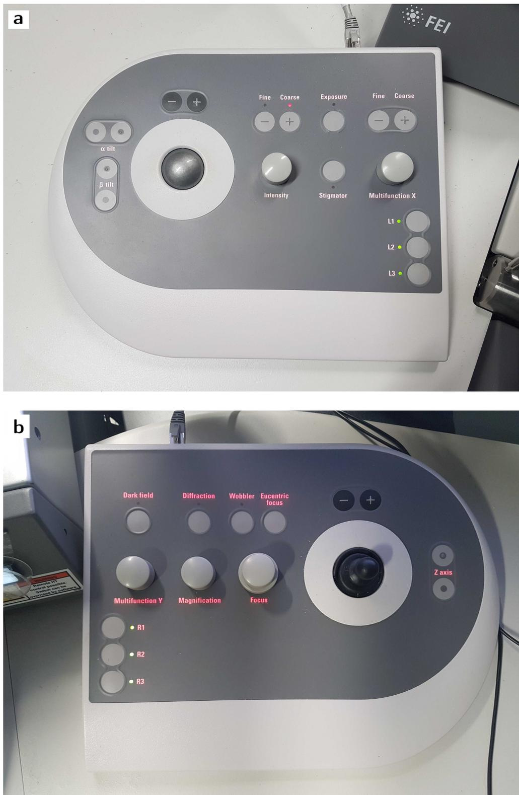
Abbildung 7: Bedienpulte die zur Steuerung des Mikroskops verwendet werden. a) linkes Bedienpult und b) rechtes Bedienpult
