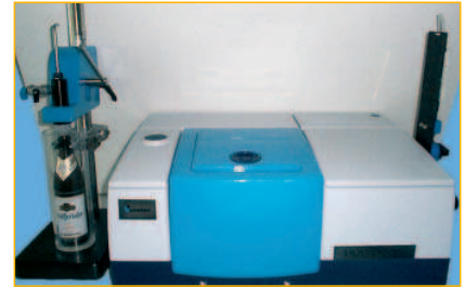
Abb. 2: a) Druckfeste ATR-Messzelle; b) Liquilyzer mit Anstechvorrichtung
